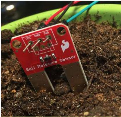
**C**oncernant le sol, les gens utilisent généralement des capteurs de sol pour le suivi en fonction de leurs besoins. La quantité d'eau dans le sol est mesurée ou estimée à l'aide de capteurs d'humidité du sol. Ces capteurs peuvent être fixes ou mobiles, comme des sondes portatives. Les sondes d'humidité du sol portables peuvent tester l'humidité du sol sur de nombreux sites, tandis que les capteurs fixes sont placés à des emplacements et à des profondeurs prédéterminées sur le terrain.
